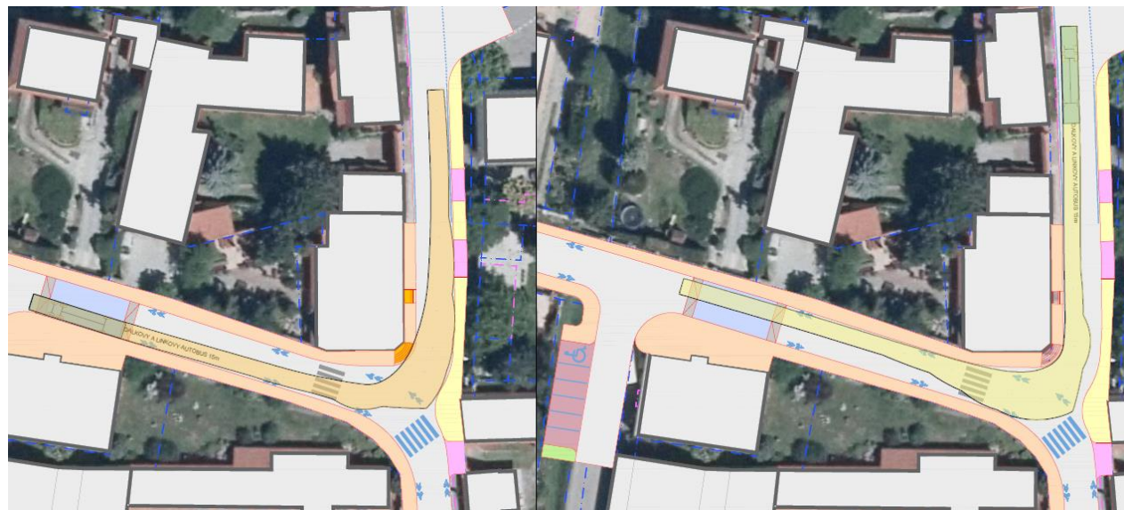
Obrázek 38 – Vlečné křivky autobusu (15 m)
