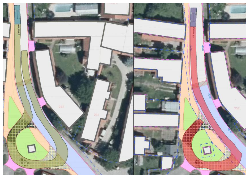
Obrázek 31 – Kaplička – Vlečné křivky průjezdu autobusu o délce 8,5 m – sever
