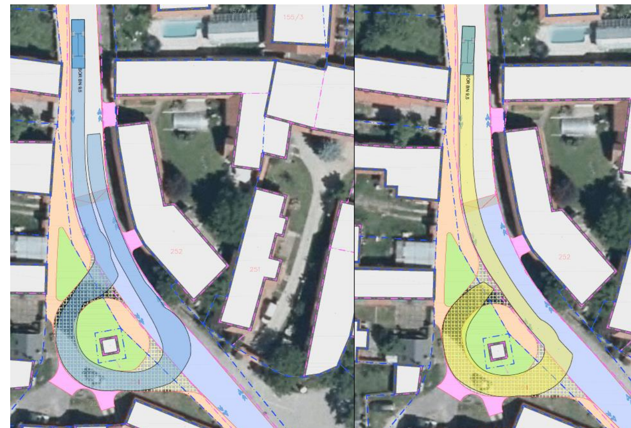
Obrázek 32 – Kaplička – Vlečné křivky průjezdu autobusu o délce 9,5 m - sever
