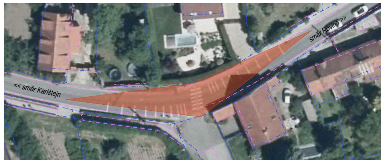
Obrázek 23 – Rozhled na přechodu pro chodce u lávky
